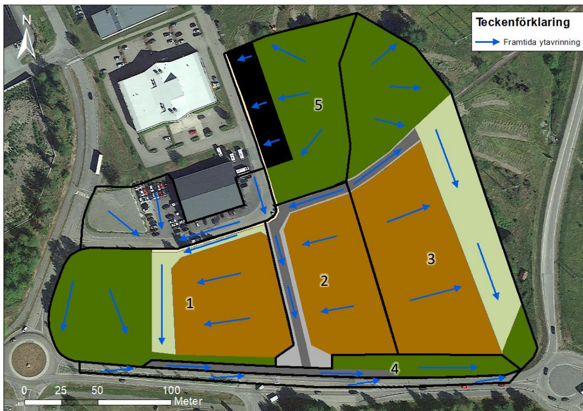
Figur 4-2. Framtida delavrinningsområden och områden med tillkommande dagvatten samt ungefärlig avrinningsriktning efter planerad exploatering.
