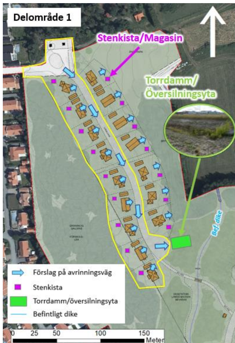
Figur 13. Förslag på systemlösning för delområde 1 (gul markering). Närliggande LOD-område presenteras också. Bakgrund: Ortofoto från Lantmäteriets visningstjänst.
