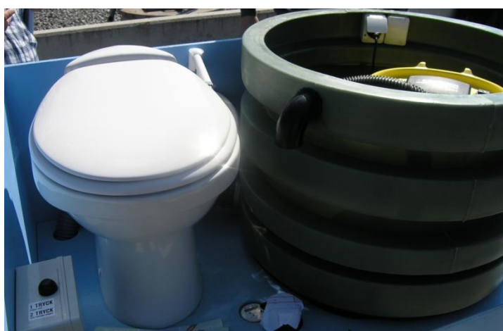
Figur 5. Exempel på toalettsystem med vakuumtoalett och sluten tank (uppställt för demonstration). Elektronikbox för styrning längst ned till vänster, till höger uppsamlingstank med vakuumenthet.
