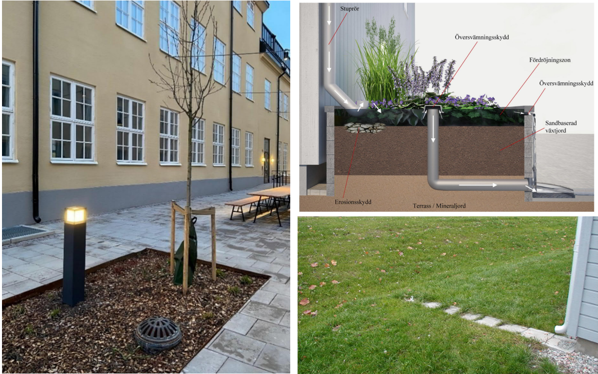
Figur 18. Till vänster: Takvatten leds ut via rännalsplattor till växtbädd/trädplantering. Bildkälla: WSP Ovan till höger: Typupbyggnad av en upphöjd växtbädd. Bildkälla: Tengbomgruppen. Nedan till höger: Takvatten leds ut på gräsyta via rännalsplatta. Bildkälla: Stockholm Vatten och Avfall
